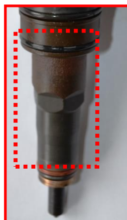
Koroze těla vstřikovače
